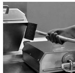
**(Remarque :** Pour les grils à 3 plaques, baisser la plaque du centre. Appliquer le nettoyant aux deux côtés de la plaque du centre et aux bords intérieurs des plaques de droite et de gauche. Lever la plaque du centre.)
