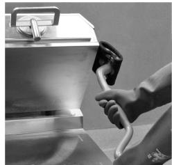
Frotter les deux côtés de la plaque du centre et les bords intérieurs des plaques de droite et de gauche. Appuyer sur le bouton RAISE (lever) pour lever la plaque du centre.)
