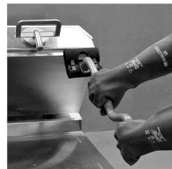
Pour les souillures tenaces, appliquer davantage de nettoyant pour gril et frotter légèrement.
