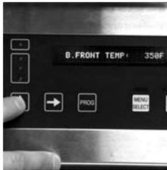
Pour augmenter la température du grill de manière à ce qu'elle corresponde à la température du pyromètre, appuyer sur la flèche ascendante. Pour diminuer la température, appuyer sur la flèche descendante.
