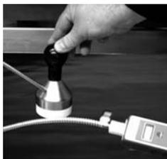
Se a temperatura exibida no controlador possuir uma diferença superior a 5 °F/3 °C em relação àquela exibida pelo sensor de superfície do pirômetro, faça o seguinte:
