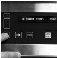
Para aumentar la temperatura de la parrilla e igualarla con la temperatura del pirómetro, oprima la tecla de flecha ascendente. Para reducir la temperatura, oprima la tecla de flecha descendente.
