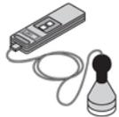
Pirómetro con sonda superficial
