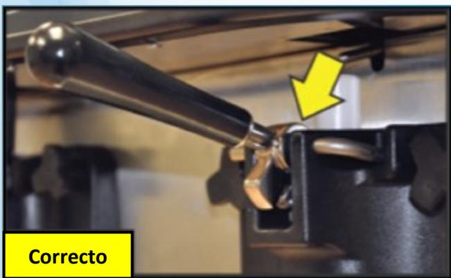
Asegúrese de que la manija de extracción de helado suave esté instalada correctamente (no al revés). El tornillo de ajuste debe mirar hacia la puerta del congelador.
